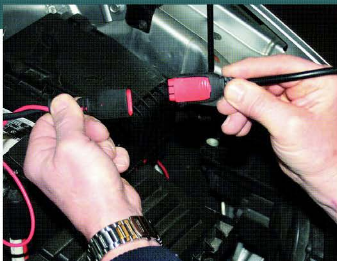
HURTIGKOPLING: Enkelte ladere har hurtigkopling som gjør det sikrere og lettere å kople til laderen.
